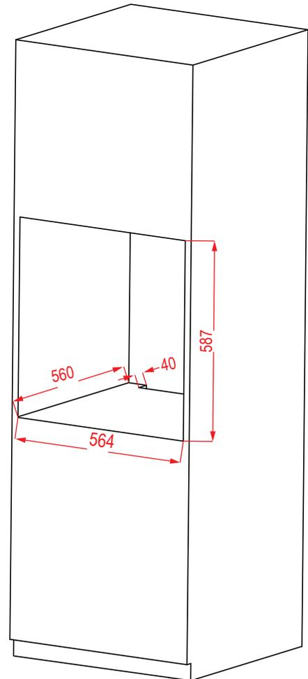
Para assegurar a ventilação adequada, deve ser removido o painel traseiro do nicho.
