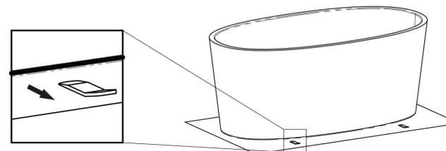
\* Após 24h da vedação com silicone, retirar os calços e preencher os espaços com silicone.
